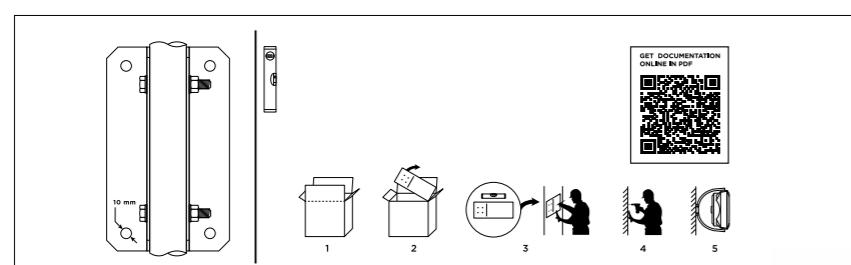
На картонной упаковке агрегатов VOLCANO нанесён шаблон с указанием монтажных размеров между крепежными отверстиями и линиями для горизонтального монтажа, облегчающий крепление консоли к стене. Достаточно отрезать шаблон с верхней части упаковки и можно приступать к монтажу агрегата.
