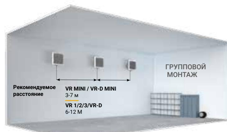
В состав стандартной комплектации воздушно-отопительного агрегата VOLCANO входит монтажная консоль, обеспечивающая возможность крепления агрегата, как к стене, так и к потолку.
